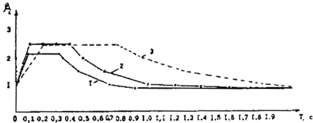
Hình 1-2: Các đường cong phổ phản ứng
