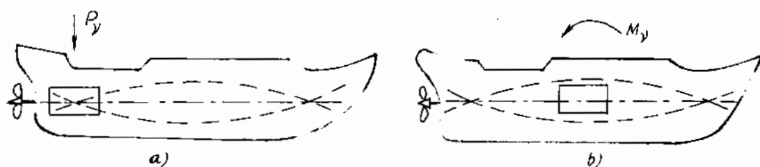
Hình 1.10. Vị trí đặt động cơ : a - khi có lực không cân bằng ; b - khi có mômen không cân bằng.
