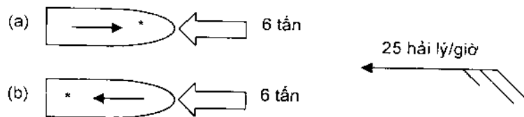
Hình 2.1. Ảnh hưởng của gió ngược khi tàu chạy tới (a) và khi chạy lùi (b). Điểm đánh dấu * là tâm quay "Pivot Point".
