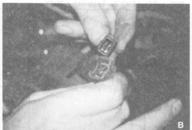
HÌNH 6 – 57. (a) Hệ thống đánh lửa có bộ chia điện của hãng Ford thường có đầu nối SPOUT. Khi kiểm tra hiệu chỉnh thời điểm đánh lửa thì phải tháo đầu nối SPOUT ra (b). Đối với hệ thống đánh lửa DIS hay EDIS thì đầu nối này có tên là SPOUT/SAW.
