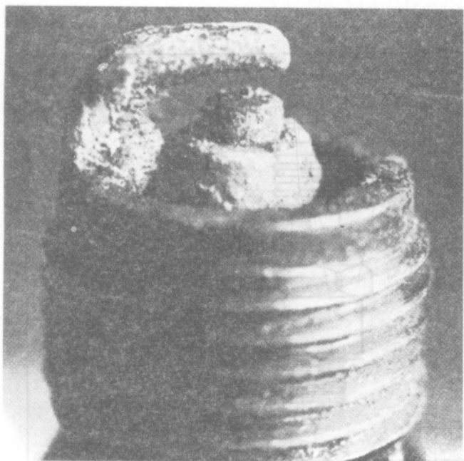
HÌNH 6 – 6. Nhìn bu-gi thấy đầu điện cực mòn chứng tỏ bu-gi dùng đã lâu, có cặn bã bám xung quanh cho thấy nhớt xâm nhập vào buồng đốt.
