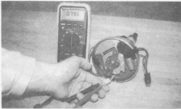
HÌNH 6 - 44. Đo điện trở cuộn pick up HEI bằng ôm kế số. Chỉ số điện trở đo được là 0,796 kΩ hay 796 Ω trong khi thông số kỹ thuật cho phép là 500 Ω - 1500 Ω. Như vậy cuộn kích hoạt này còn sử dụng được.
