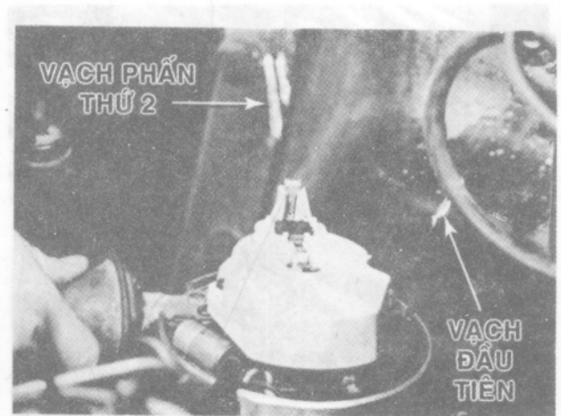
HÌNH 6 – 62. Đây cũng là 1 trong những cách rút bộ chia điện ra khỏi động cơ, đó là phải đánh dấu để gắn vào lại chính xác. Vạch phần đầu tiên là hướng của mũi rô-to khi chưa rút bộ chia điện ra. Vạch phần thứ 2 là hướng của mũi rô-to sau khi rút ra. Khi ráp vào thì đặt mũi rô-to hướng về vạch phần thứ 2 rồi mới đút vào lỗ. Nếu mũi rô-to chỉ đúng vạch phần đầu tiên là đúng. Nếu sai thì phải làm lại.
