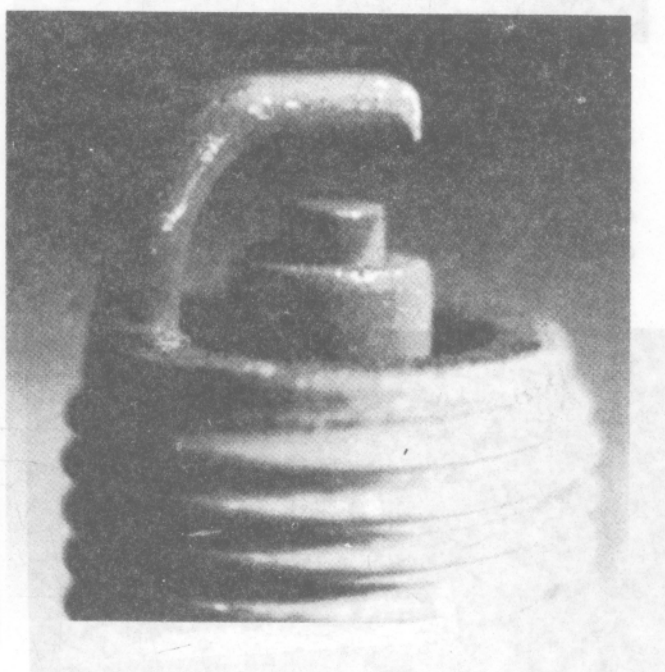
HÌNH 6 – 7. Đây là bu-gi mới tốt nhưng bị ứt do hòa khí quá đậm. Nếu chỉ có 1 hoặc 2 bu-gi bị ứt thì do kim phun sắp hư (thường là bị kẹt mở).
