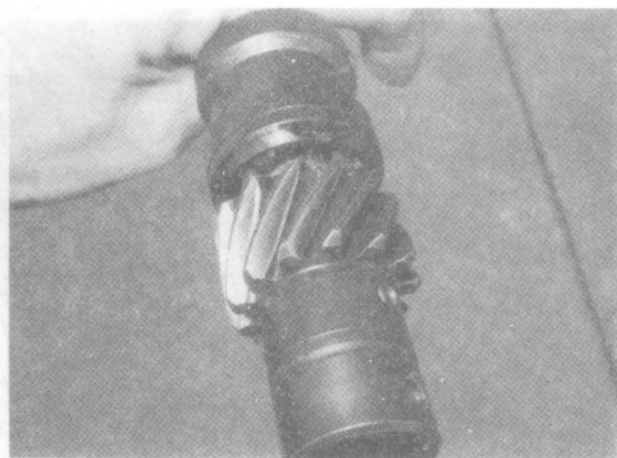
HÌNH 6 – 64. Bánh răng cốt bộ chia điện mòn làm cho tín hiệu vị trí cốt cam sai lệch. Dĩ nhiên bánh răng trên cốt cam cũng mòn nên khi thay phải thay cả hai.
